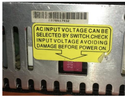
Fig.8 – Tensão da Fonte: O ajuste da tensão, padrão de fábrica, é de 220V.
