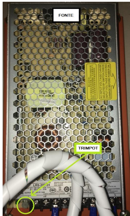
Fig.9 – Ajuste da Intensidade da Luminância: O ajuste da intensidade de luminância é realizado através do Trimpot da Fonte, somente por pessoal autorizado Ortosintese.
