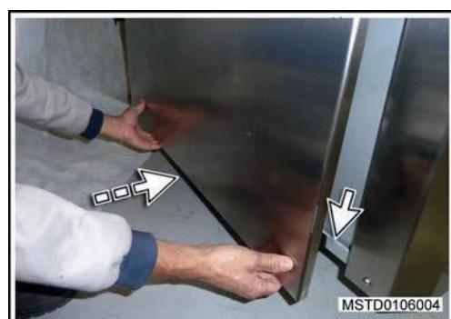
2. Empurre a parte inferior do painel contra a cantoneira da estrutura inferior da Termodesinfectora até que as faces do fecho “velcro” tenham contato e se acoplem.
