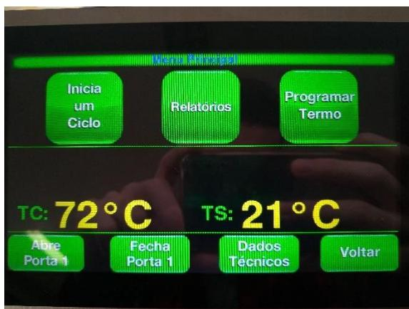
1. Com a Termodesinfectora ligada e o painel mostrando a tela principal, pressione a tecla "Dados Técnicos" para verificar os registros memorizados.
