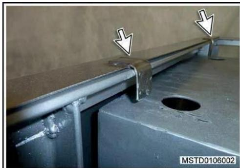
2. Ainda segurando a parte inferior com as duas mãos, empurre a placa para cima e libere o gancho de apoio da parte superior.
