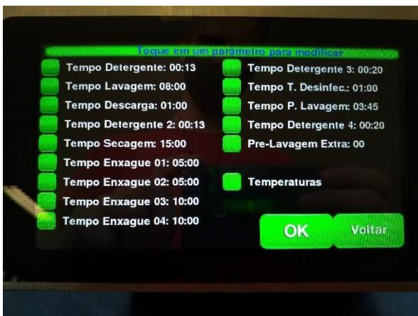
Para melhor entendimento, a imagem ao lado demonstra um ciclo configurado com as 4 injeções de detergente sendo utilizadas.
