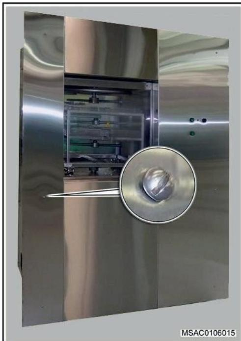
3. Remova os parafusos de fixação do painel frontal do lado de saída (barreira) e remova o painel.
