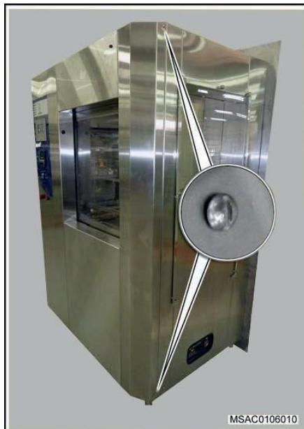
1. No lado oposto ao do painel de controle, remova os parafusos de fixação do painel de acabamento.
