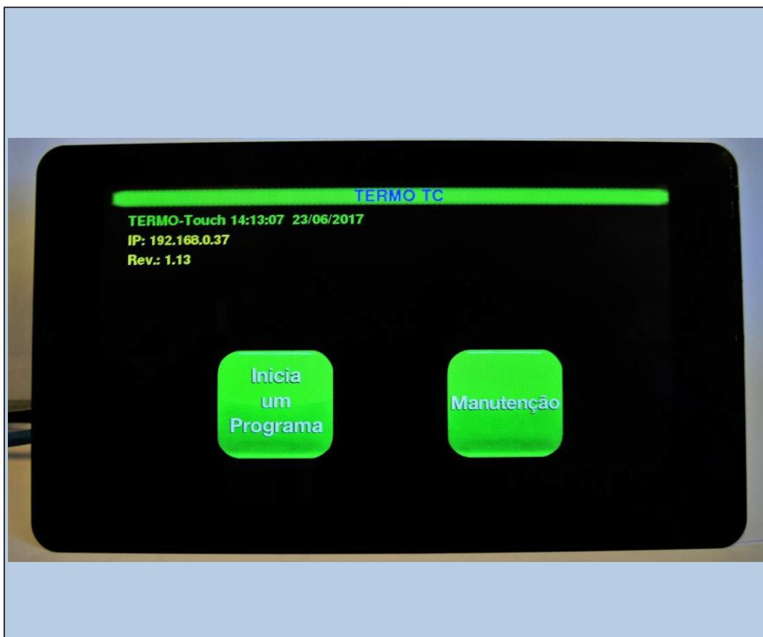
As Termodesinfectoras fabricadas pela Ortosintese são equipadas com IHM com tela tipo *Touch Screen* com display de 7".
